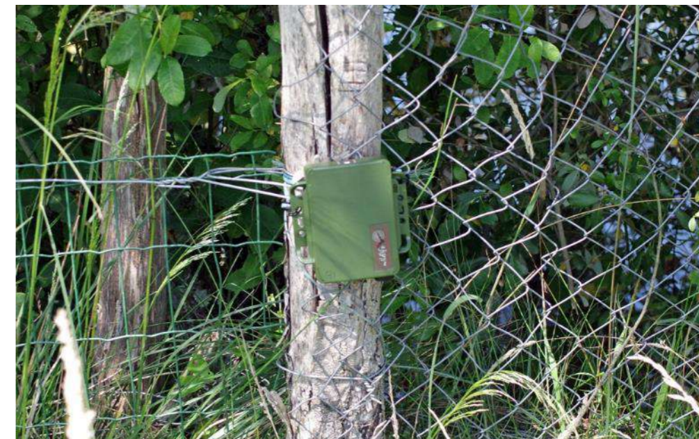
Figure 124 : Détecteur d'ultrasons SM-mini aux abords de l'étang
